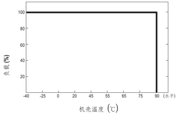
© 如果HVGC-480以额定电流工作在恒功率模式，最大可工作环温为55°C (Typ. 230VAC)
