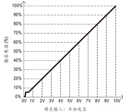
◎ 用外加10V PWM信号(频率范围:100Hz~3KHz):
