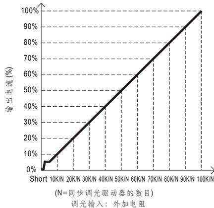
备注: 1. 最小调光比例约为6%左右, 当输出电流0%<I<sub>out</sub><6%, 输出电流精度不做定义。
