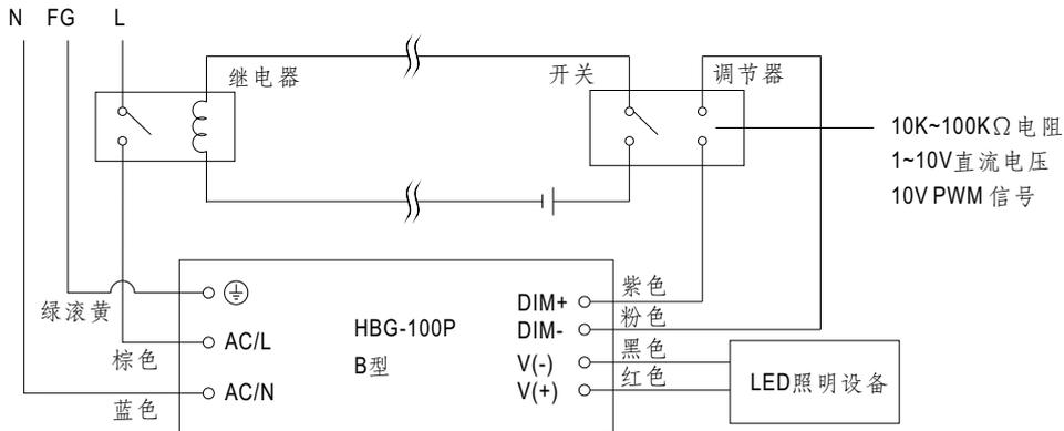
使用一个开关和继电器可以打开/关断照明设备
