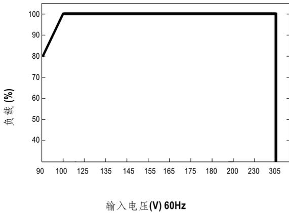
※ 低输入电压情况下需减额输出
